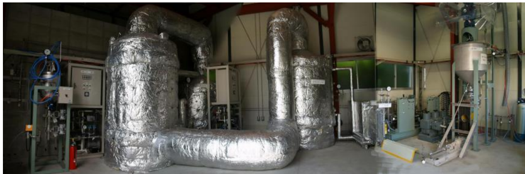
図1 東広島にある1t/日の超臨界水ガス化パイロットプラント
