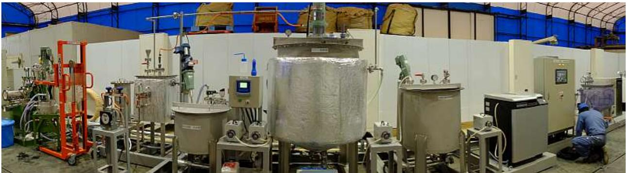
図1 南相馬市に設置した木質バイオマスメタン発酵パイロットプラント
