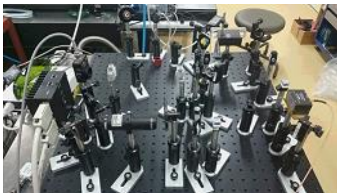
自作の半導体レーザー吸収分光システム
