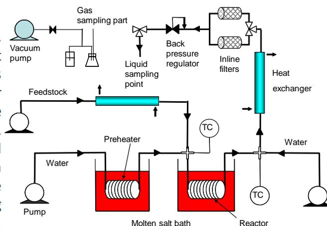
Fig. 1 Experimental apparatus
