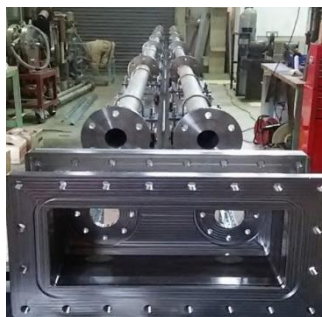
図1 無隔膜衝撃波管の外観(左)とn-C 7 H 16 の着火遅れ
